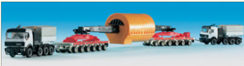
B-13507 Straßentransport eines Generatorstator mit Durchsteckträger
