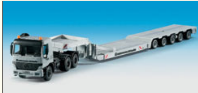
B-13538 MB ACTROS 3achs Zugmaschine GROHMANN ATTOLLO mit SCHEUERLE Tiefbetaufleger
