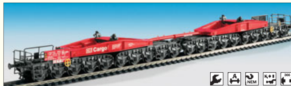
B-16506 Schientiefladewagen Uaai 836 kurzgekoppelt
