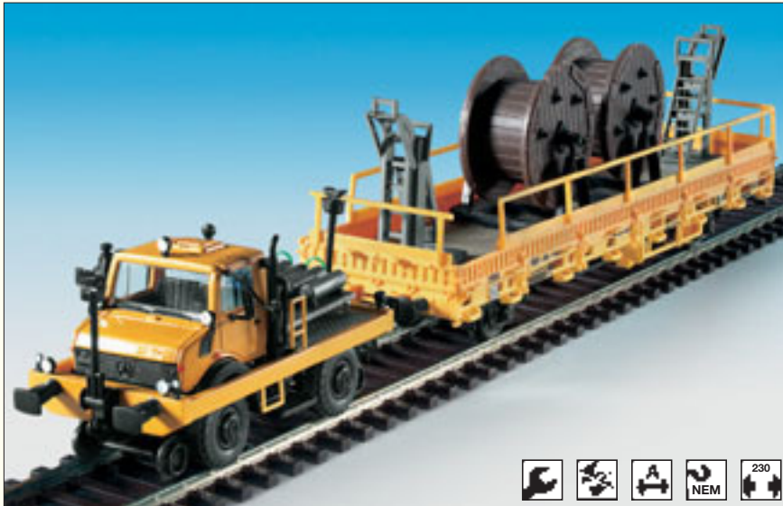
B-16062 Zweibege UNIMOG mit Zug- und Schubrahmen mit Fahrleitungsbauwagen
