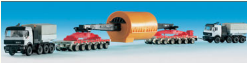
B-13507 Straßentransport eines Generatorstator mit Durchsteckträger
