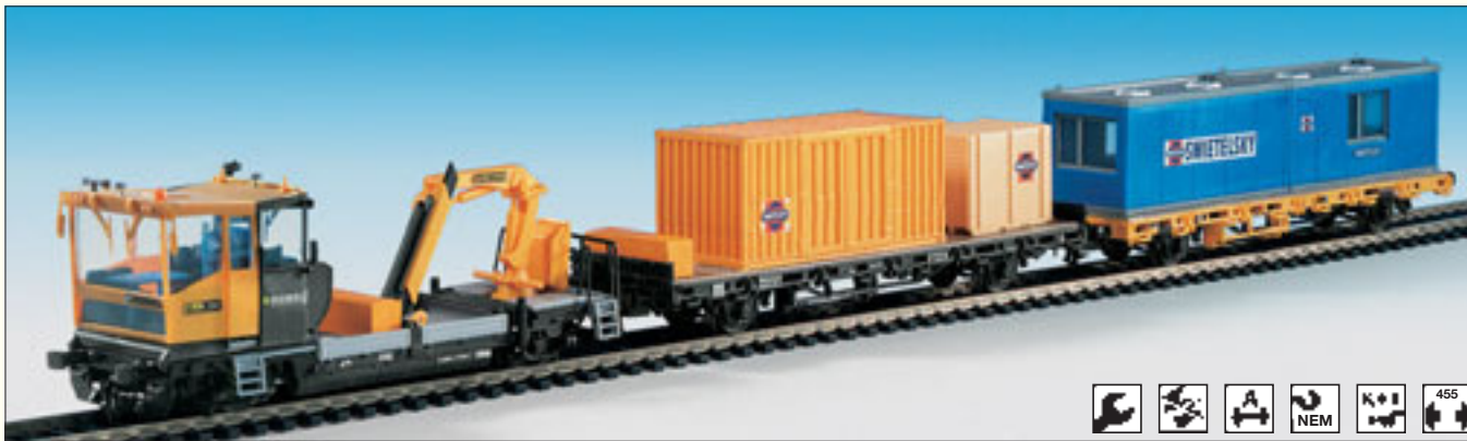
B-16602 Bauzug bestehend aus Gleiskraftwagen BULLOK und zwei Flachwagen mit Material- und Unterkuftscontainern
