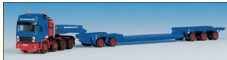
B-13553 MAN 3achs Zugmaschine mit Hochdach, 1achs Dolly und Plattformwagen SCHEUERLE mit Tiefbett
